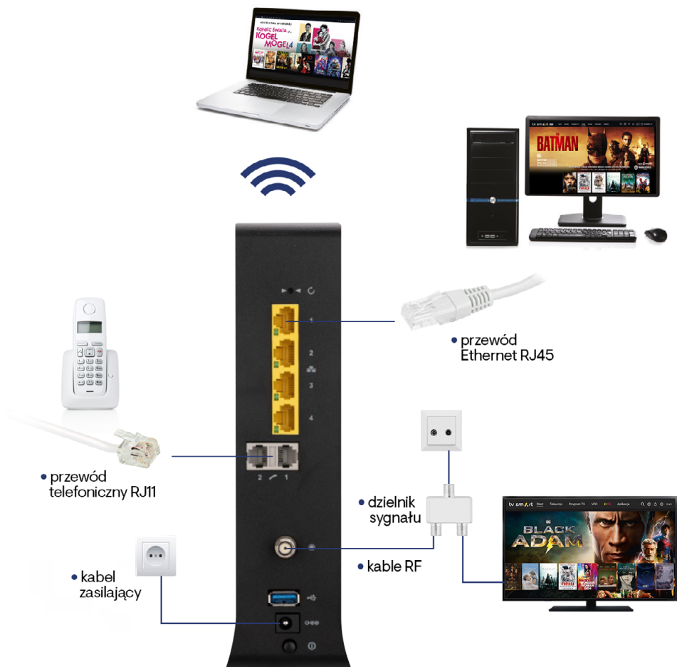
Zdjęcie 3. – Schemat podłączenia modemu.
